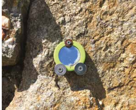
Specchio con le tre viti di regolazione per orientare la macchia solare
