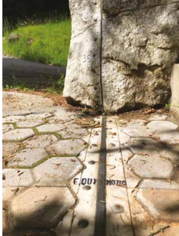
A sinistra della linea meridiana le borchie indicano i gradi dell'altezza del Sole
